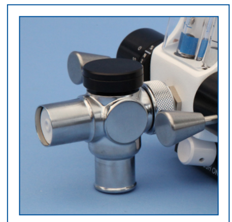
Ventilstycke med ventil för förhindrad återvändning av använda gaser samt ventil för akut lufttillförsel av rumsluft om gasflödet avbryts.
