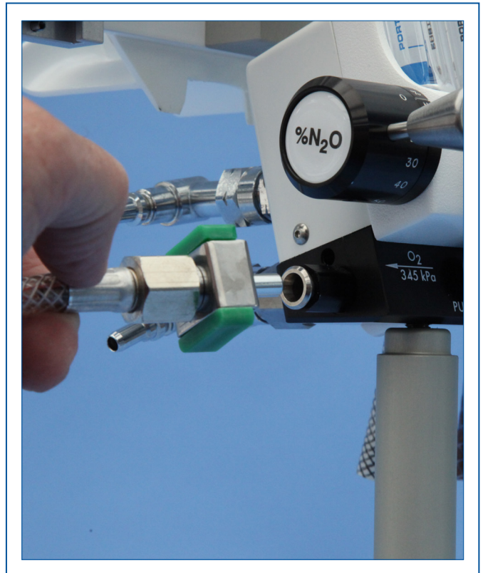
Uttag för akutmaskset (helmask) - anslutning av fullmask för akut tillförsel av 100% medicinskt oxygen.
